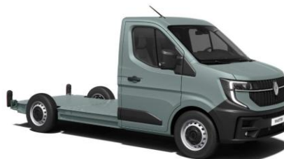
sasiu platou fix fara perete despartitor in spatele scaunelor
